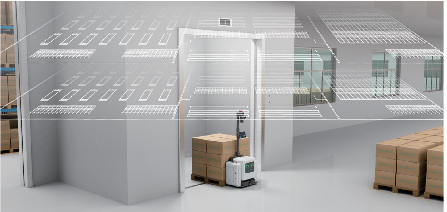
층간 이동 및 운반 능력을 갖추고 있어 다층, 다구역의 자재 운송 수요를 충족하며 설비 제어 시스템 MW-WCS를 통해 엘리베이터 또는 자동문과 연동하여 스스로 엘리베이터 호출 및 탑승 그리고 자동문 출입을 함으로서 구역 제한없이 작업이 가능합니다.
